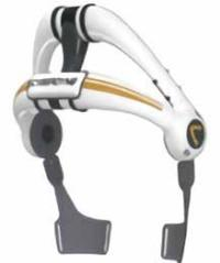
HAL® 腰タイプ自立支援用は、足腰の弱った方などの体幹・下肢のトレーニングを補助する装着型ロボットです。
