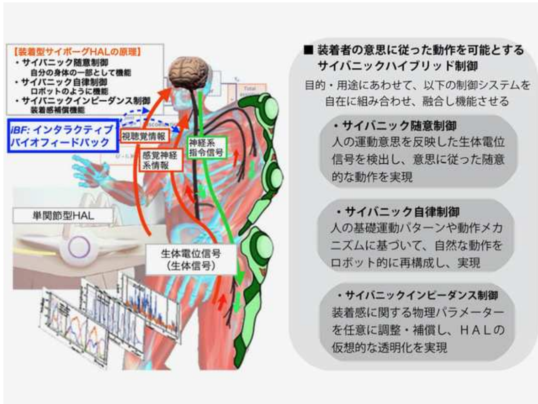
図1 HAL®の動作原理
