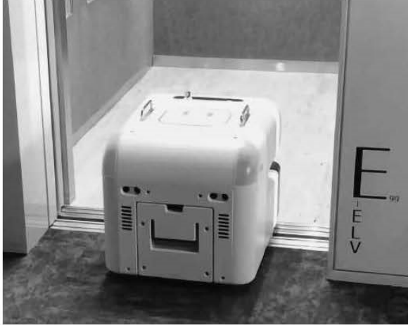
「CL02」エレベーターに乗り込む清掃ロボット
